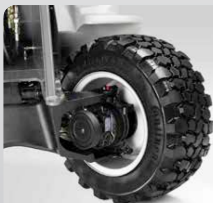
Двигатель, установленный в ступице колеса 5025, 5035
