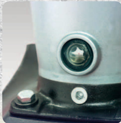
Система трамбовки с устройством контроля уровня масла
