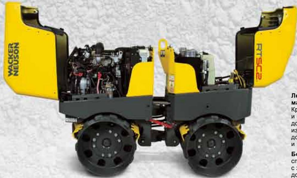
**Легкий доступ к компонентам машины.** Крышка RT легко открывается и обеспечивает оптимальный доступ к деталям. Она изготовлена из высокопрочного, долговечного, нержавеющей и ударостойкого материала.
