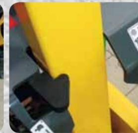
3 Защелкнуть рукоять. Принудительный фиксатор обеспечит безопасную транспортировку, так как он надежно удерживает направляющую рукоять.
